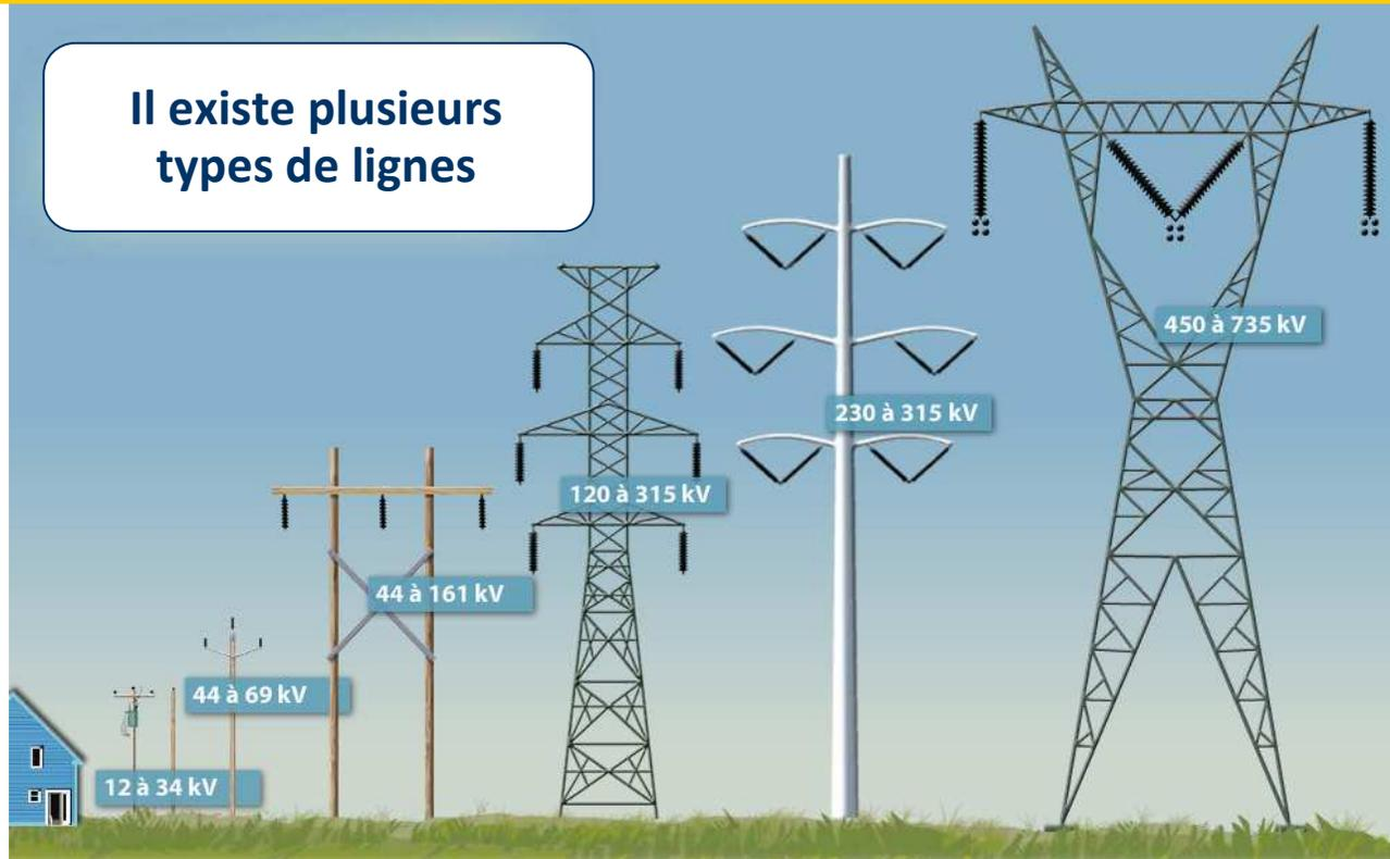
C'est l'air qui entoure les fils des lignes qui les isole. Chaque type de ligne nécessite un corridor dégagé plus ou moins large que l'on appelle emprise. Plus la tension de la ligne est élevée, plus l'emprise doit être large.
